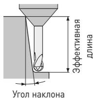
Сферические концевые фрезы с длинной шейкой с алмазным покрытием идеально подходят для чистовой обработки поверхности неметаллических материалов.
